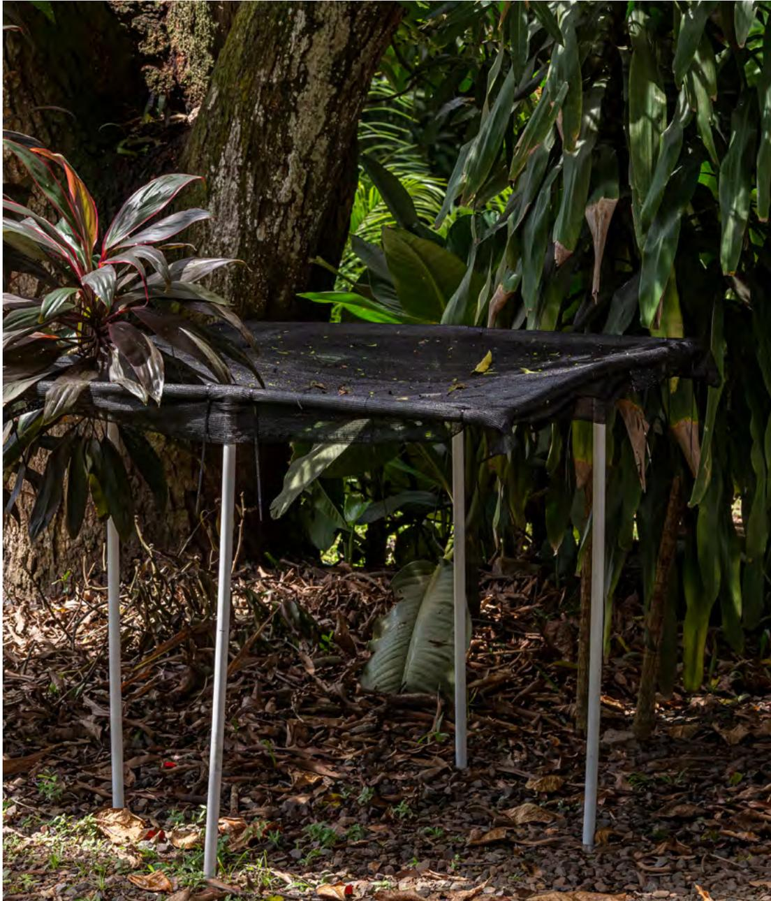
Las trampas de hojarasca son dispositivos fundamentales en los estudios ecológicos, que se utilizan para analizar las dinámicas de descomposición y los ciclos de nutrientes en los ecosistemas terrestres. Estas trampas consisten en una estructura tubular de PVC que sostiene una fina malla o red diseñada para recoger el material vegetal muerto que cae de los árboles y plantas cercanos, como hojas, flores, frutos, ramas e incluso semillas.
